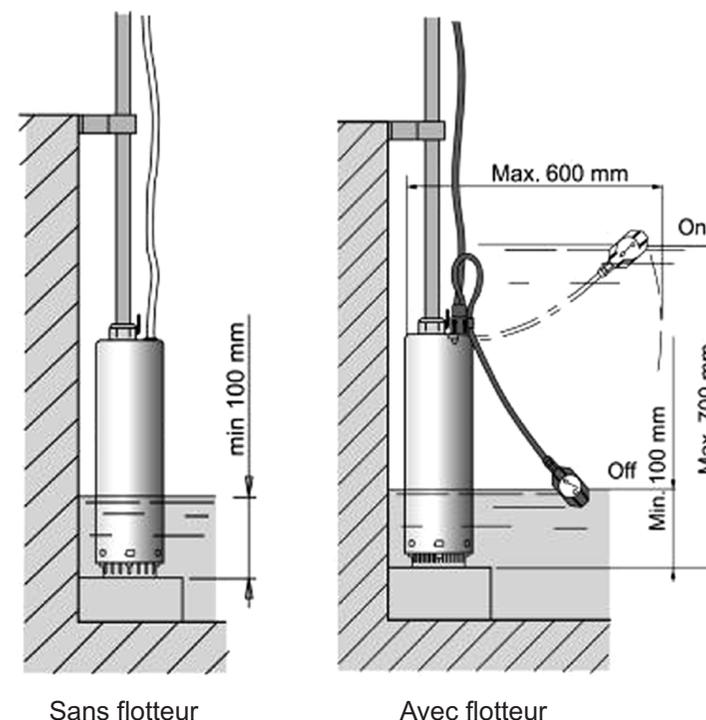
La pompe peut reposer au fond d'un réservoir sur une surface plane.
